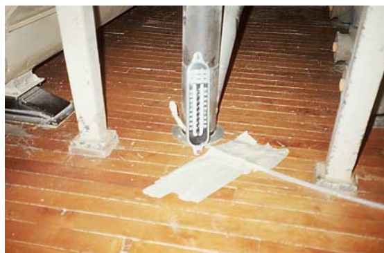
La température a été mesurée au niveau du plancher. Des tubes ont servi à échantillonner le milieu de fumigation à partir de l'extérieur de l'aire expérimentale
