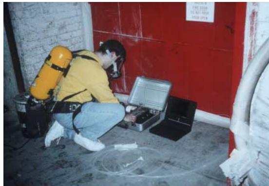
Mesures de la concentration de phosphine derrière une porte étanchéifiée. Dean Stanbridge porte un ARA par mesure de sécurité.
