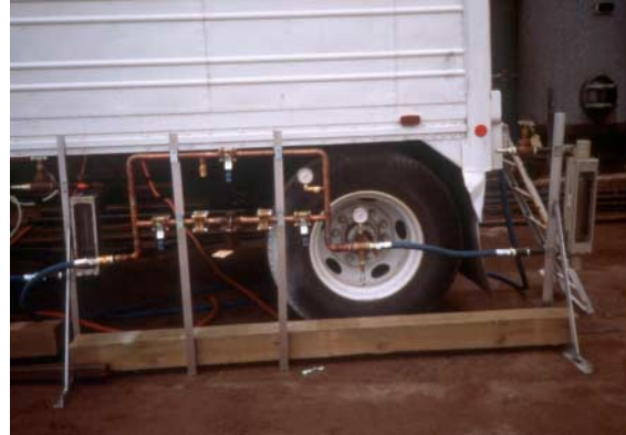
La remorque de Praxair montrant le distributeur et les divers systèmes pour mesurer le CO 2 .
